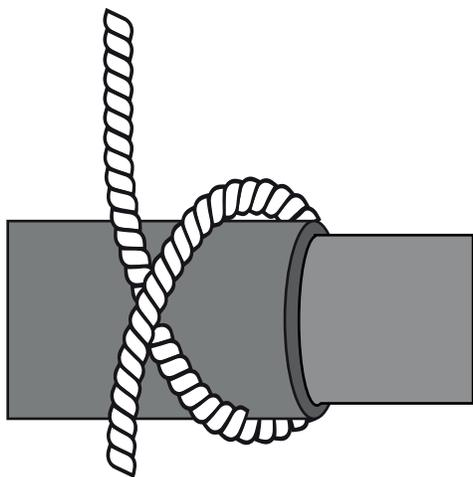
Conectar la boquilla de entrada de aire en el motor, sujetarla fuertemente con los velcros y la cuerda
